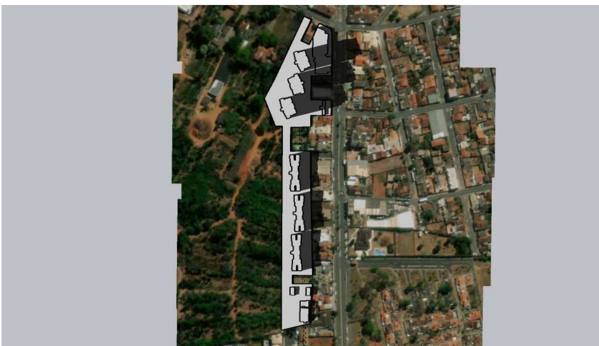
Figura 66 – Projeção da sombra do empreendimento após alteração: solstício de verão 16:00h. Fonte: Simulação realizada com base na proposta de alteração de projeto, 2024.
